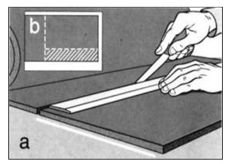
4.2.4. После того, как поверхности будут очищены, и необходимый кусок материала будет отрезан, отклейте защитную плёнку с одного конца листа ТЕРМОФОЛ и закрепите его на поверхности воздуховода. Постепенно удаляя защитную плёнку, прижимайте самоклеющийся материал к изолируемой поверхности, обязательно прикатывая его обрезиненным роликом для удаления пузырьков воздуха из места склеивания и для обеспечения алгезии клея.
