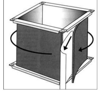
4.2.5. Приклейте самоклеющуюся изоляционную ленту ( скотч PE) на стык самоклеящегося материала на ребре воздуховода, или заклейте скотчем PP в случае применения материала, ламинированного отражающей лавсановой плёнкой. Гарантию качества обеспечит специальный Армированный скотч из материала Термофол ФТ2 СК, ФТ5 СК или Термофол ППА СК, поставляемый в виде лент шириной от 50 до 200мм, смотанных в ролики с длиной намотки 25 и 50 м
