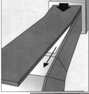
4.2.7. Если по условиям эксплуатации по воздуховоду транспортируют воздух с температурой ниже температуры окружающей среды, необходимо тщательно склеить вместе края листов с помощью клея «88 люкс» и заклеить стык скотчем РР, РЕ или лентой из основного материала в зависимости от типа покрытия внешней стороны листа (см. п.5)
